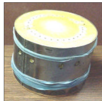
Mould shell ready to pour.
